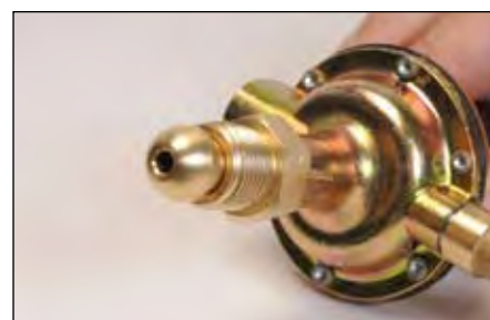
3. Attacco POL dado esag. CH 25 G 5/8" Masch. Sin.
