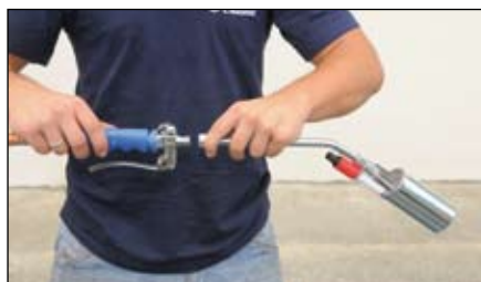
2. Accrocher le rouleau de compression avec manche latéral au chalumeau et le fixer avec un boulon et un écrou à papillon
